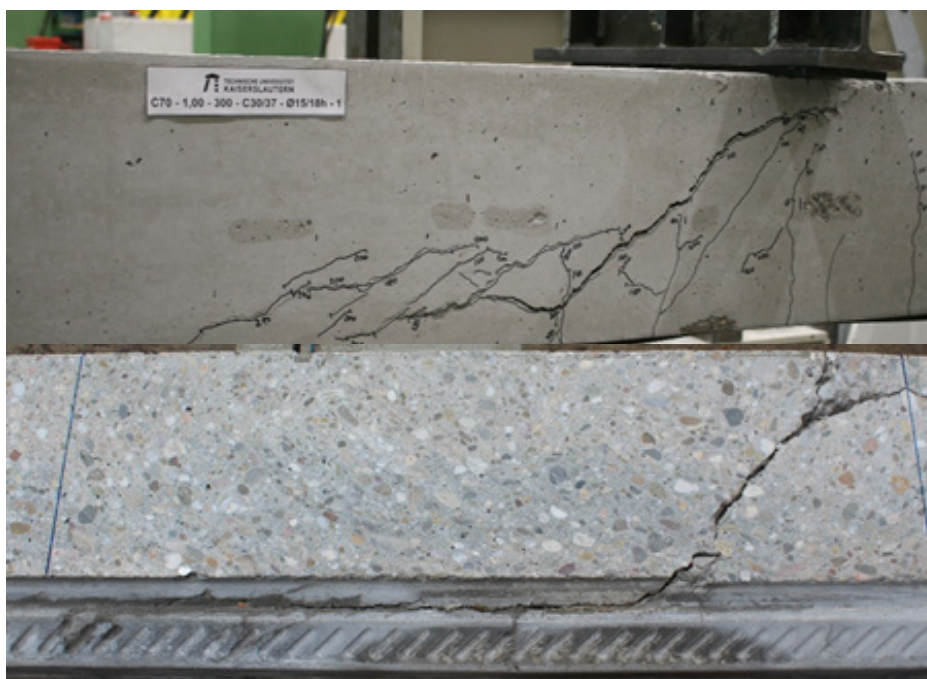
Bild 1: Maßgebende Schubbrissbildung an der Bauteiloberfläche sowie im Inneren eines Versuchskörpers.
